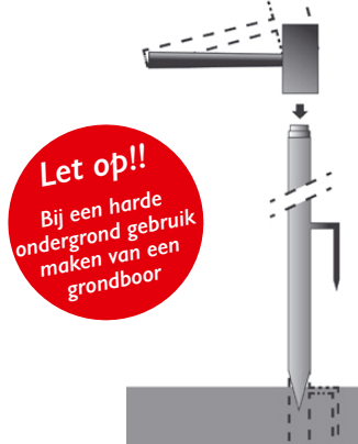
Figuur 2: Sla de grondbuis, na plaatsing van de slagpen, stevig in de grond. (met Anti-rotatie pin)
