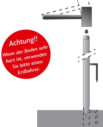
Abb. 2: Detailansichten : (Sicherungspin zur Verhinderung von Rotationsbewegungen)
