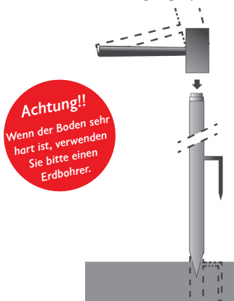
Abb. 2: Detailansichten : (Sicherungspin zur Verhinderung von Rotationsbewegungen)
