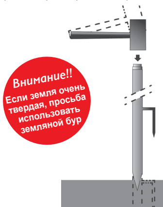
Рисунок 2: Забивание опорной трубы в землю (с анти-ротационным крепежом)
