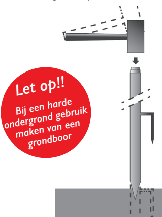
Figuur 2: Sla de grondbuis, na plaatsing van de slagpen, stevig in de grond. (met Anti-rotatie pin)
