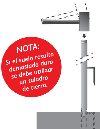
Dibujo 2: Martillar el tubo base con ancla anti-rotación en el suelo.
